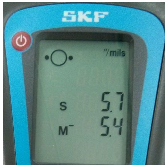
5. Afloje el asiento de sujeción y gire el acoplamiento hasta la posición de las 3 horas y apriete la prensa de sujeción. Pulse la tecla de flecha derecha. Después de algunos segundos, el círculo de posición debería mostrar dos puntos permanentes, uno en la posición de las 12 horas y uno en la posición de las 3 horas.
