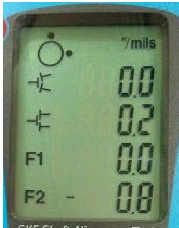
11. Si las mediciones de acoplamiento están fuera de tolerancia, afloje los tornillos de la máquina móvil y ajuste la posición horizontal de los cojinetes de apoyo a la cantidad apropiada. Al hacerlo, observe los valores en la pantalla e intente reducirlos a los valores dentro de tolerancia.
