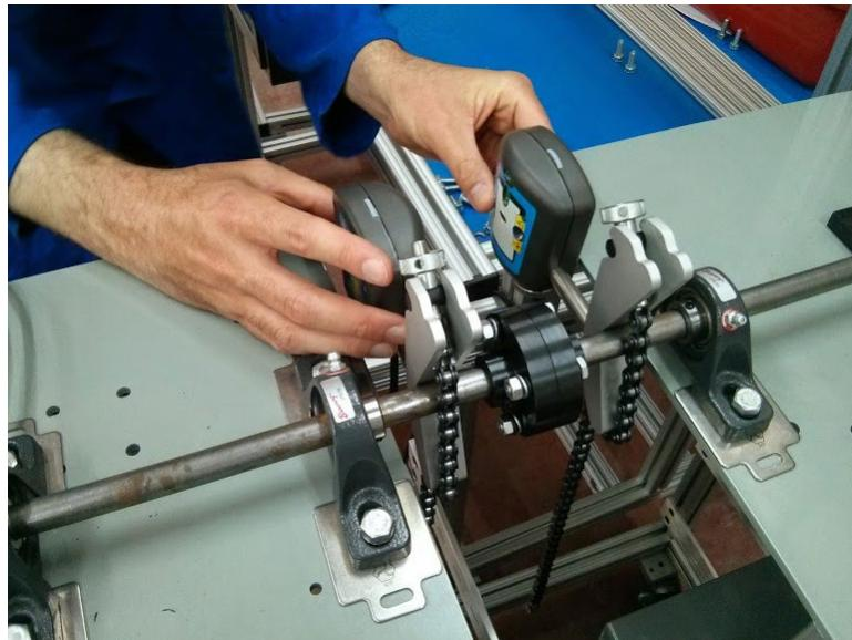
La pantalla muestra ahora el error angular y de descentrado en el plano horizontal. Apriete el asiento de sujeción y registre la desalineación angular y de descentrado en el informe de alineación. Los valores E1 y E2 muestran ahora cuánto debe moverse el cojinete de apoyo de izquierda a derecha para alinear el acoplamiento.
