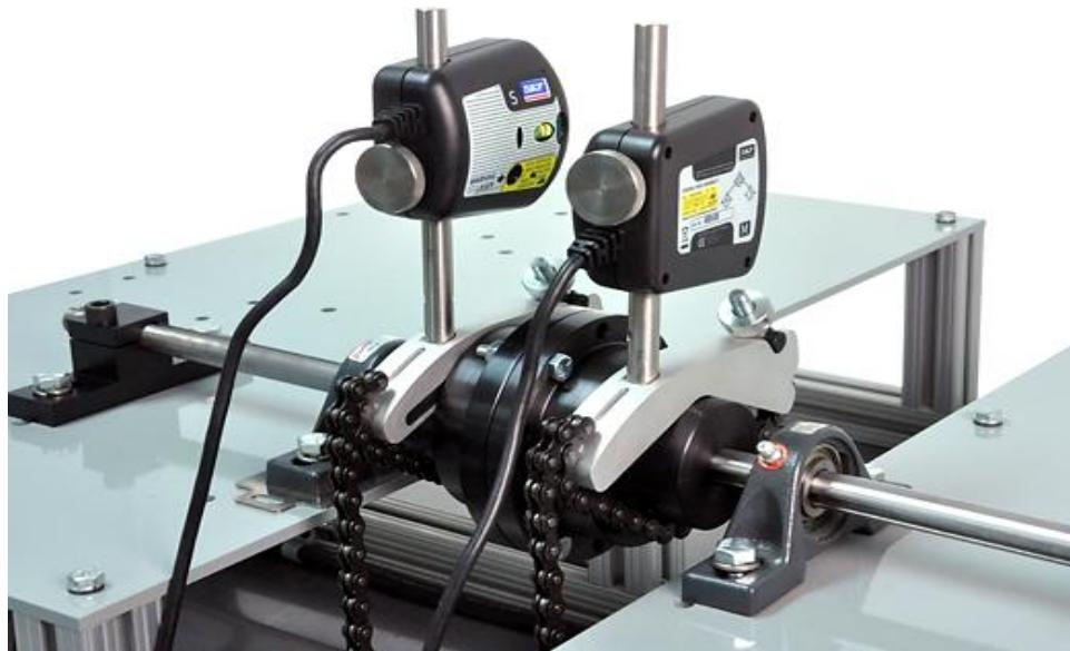
7. La pantalla muestra ahora el error angular y el error de descentrado en el plano vertical y las cuñas necesarias en las patas delanteras y traseras para corregir el error.
