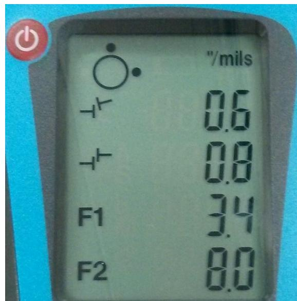
8. Registre la desalineación angular y de descentrado en el informe de alineación. Si el error angular y de descentrado no está dentro de los límites aceptados que se detallan en la tabla continuación, inserte las cuñas adecuadas para corregir el problema. A medida que ajusta la máquina, el descentrado y las cuñas restantes necesarias irán cambiando de forma dinámica en la unidad de pantalla.
